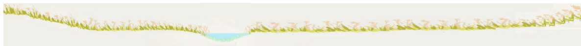
Figur 20. Skiss svackdike med översvämningszoner på båda sidor. När svackdiket går fullt sväller vattenflödet och om dikets kanter inte är för höga översvämmas omkringliggande mark, som då utgör översvämningszoner. Markytan som översvämmas av det bräddade svackdiket kan exempelvis vara en park eller fotbollsplan, GC-banor eller andra anläggningar som inte är samhällsviktigt kritiska.
