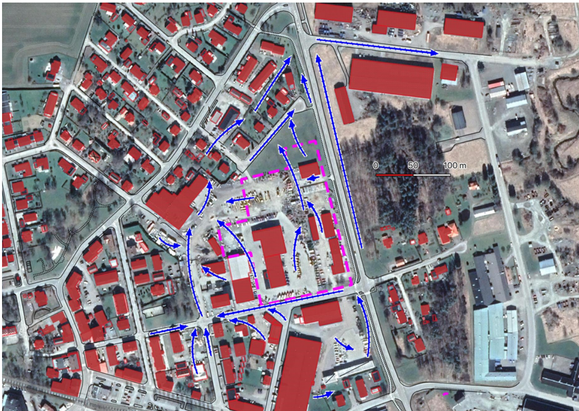
Figur 9: potentiella befintliga, ytliga rinnstråk för dagvatten vid skyfall, visade med blå pilar (ortofoto: Google Earth Pro)
