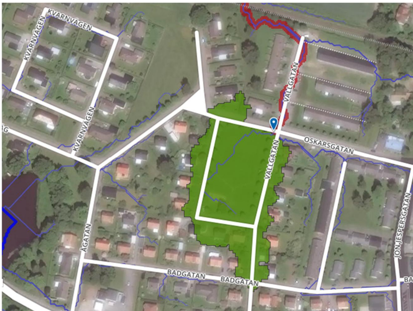
Figur 2 Vid skyfall avleds det gröna området delvis genom det aktuella planområdet vidare via Vallgatan till kulvert under järnvägen. Avledningsvägen är markerad i med rött. (ScalcoLive 2018-11-28)
