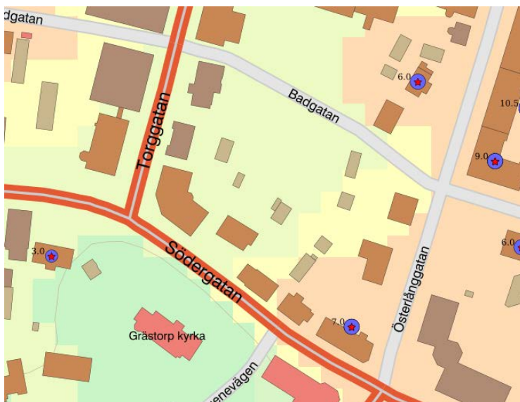
Figur 8-2. Jorddjupskarta från SGU där grön/gult visar 1-3 meter jorddjup och orange färg visar 5-10 meter djup.
